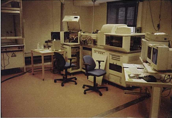
Şekil 1. ICP (inductively coupled plasma) İndüktif çiftlenmiş plazma-kütle spektrometre cihazı. (Doğa Tarihi Müzesi İzotop Jeolojisi Laboratuvarı, Stockholm-ISVEC).
